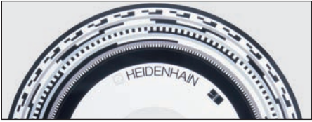
常规13条格雷码刻轨的刻线码盘
